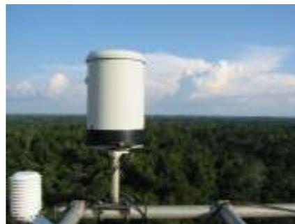
Fig. 16. Pluviômetro instalado no topo da torre micrometeorológica (63m de altura), localizada no sítio de São Gabriel da Cachoeira - AM, dentro do Parque Nacional Pico da Neblina (foto: INPA/Projeto LBA).
