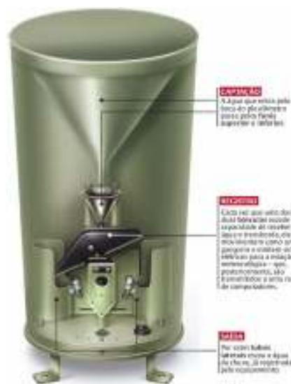
Fig. 4. Pluviômetro de balsa (ilustração: Érika Onodera)
