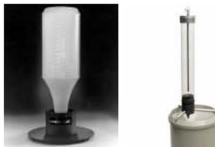
Fig. 7. Sistemas para verificação (fotos: Rain Gauge Calibrator da Climatronics e Field Calibration Device (FCD) da Hydrological)
