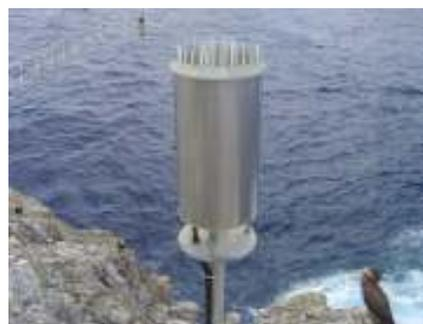
Fig. 18. Pluviômetro adaptado para o arquipélago São Pedro São Paulo, utilizado pelo INPE/CPTEC/Oceanografia (adaptação e foto: LIM/Osvaldo)
