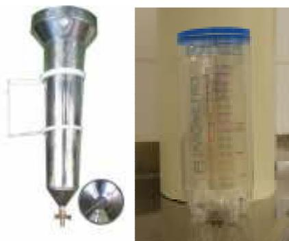
Fig. 2. Pluviômetro *Ville de Paris* (foto: *Hidrologia Ltda*) e pluviômetro didático.
