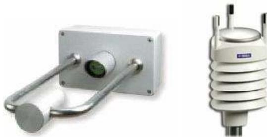
Fig. 5. Disdrômetro óptico e estação meteorológica compacta com disdrômetro por impacto (fotos: JCTM e Vaisala)
