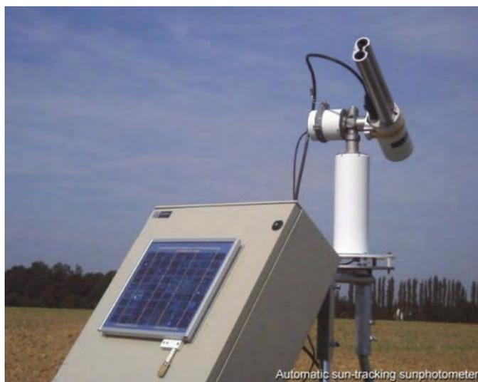
Figura 2.10 – Radiômetro espectral CIMEL Eletronique 318A.
