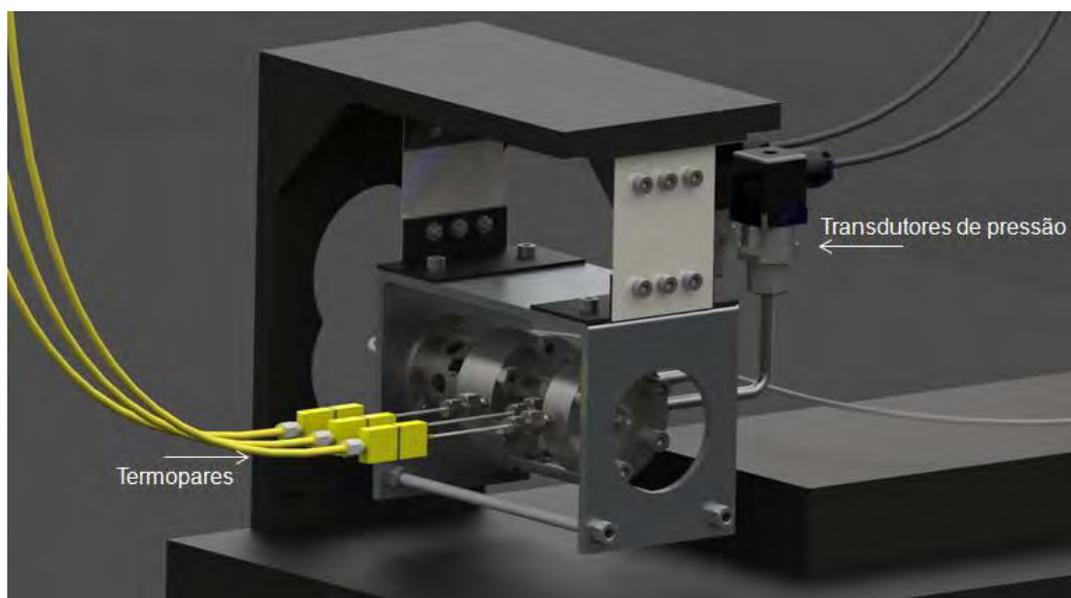
Figura 3.7 – Vista frontal da balança de empuxo
