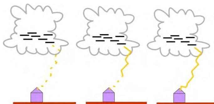
Figura 1.9 (a) Canal Ionizado (b) Líder contínuo (c) descarga de retorno subsequente
