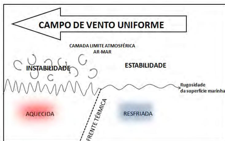
Figura 4.40 - Esquema ilustrativo da diferente resposta na rugosidade do oceano em função da ocorrência de frentes térmicas (adaptada de ROBINSON; 2004).
