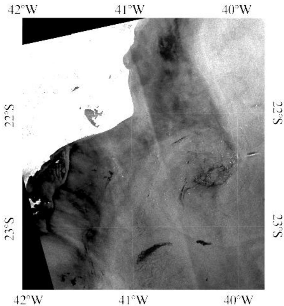
Figura 4.6 - Imagem RADARSAT-1 de 26/01/2003 (21h18min GMT). Alvos de baixo sigma-zero formado pela supressão das ondas de Bragg em áreas com biofilmes.
