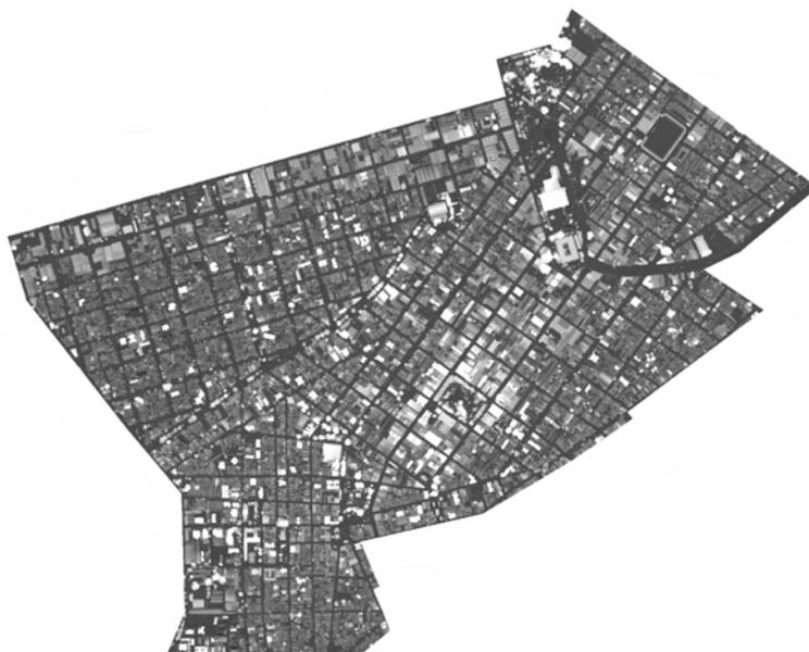
Figura 5.5 - MDA obtido pela subtração entre o MDS e o MDT.
