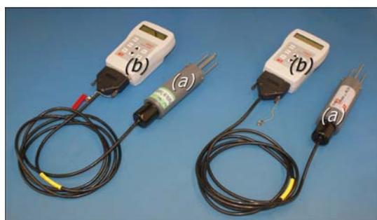
Fig. 1. Sensor de conteúdo de umidade no solo *ThetaProbe* (a) em conjunto com sistema de aquisição de dados *HH2* (b), ambos da *Delta-T Devices*
