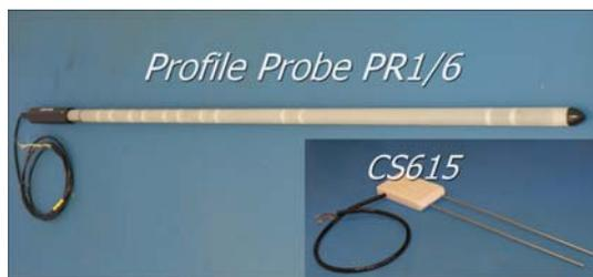
Fig. 2. Sensor de perfil de umidade do solo *Profile Probe PR1/6* da *Delta-T Devices* e sensor de umidade do solo CS615 da *Campbell Scientific*
