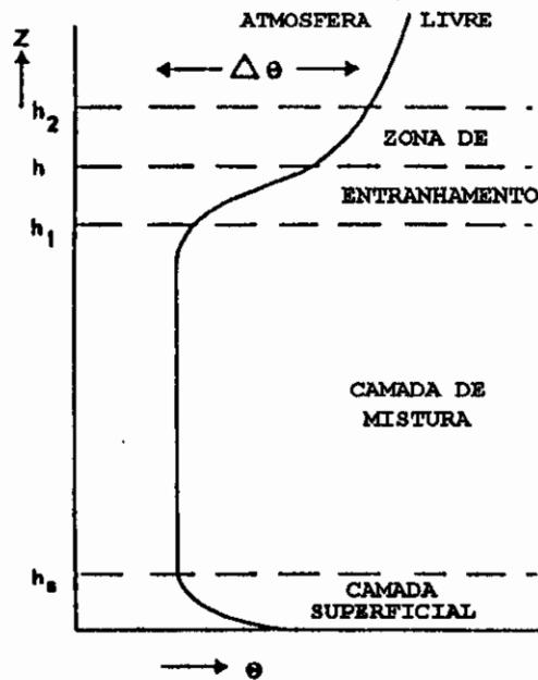
Fig 2.1 - Estrutura típica da Camada Limite Convectiva em função do perfil vertical da temperatura potencial.
