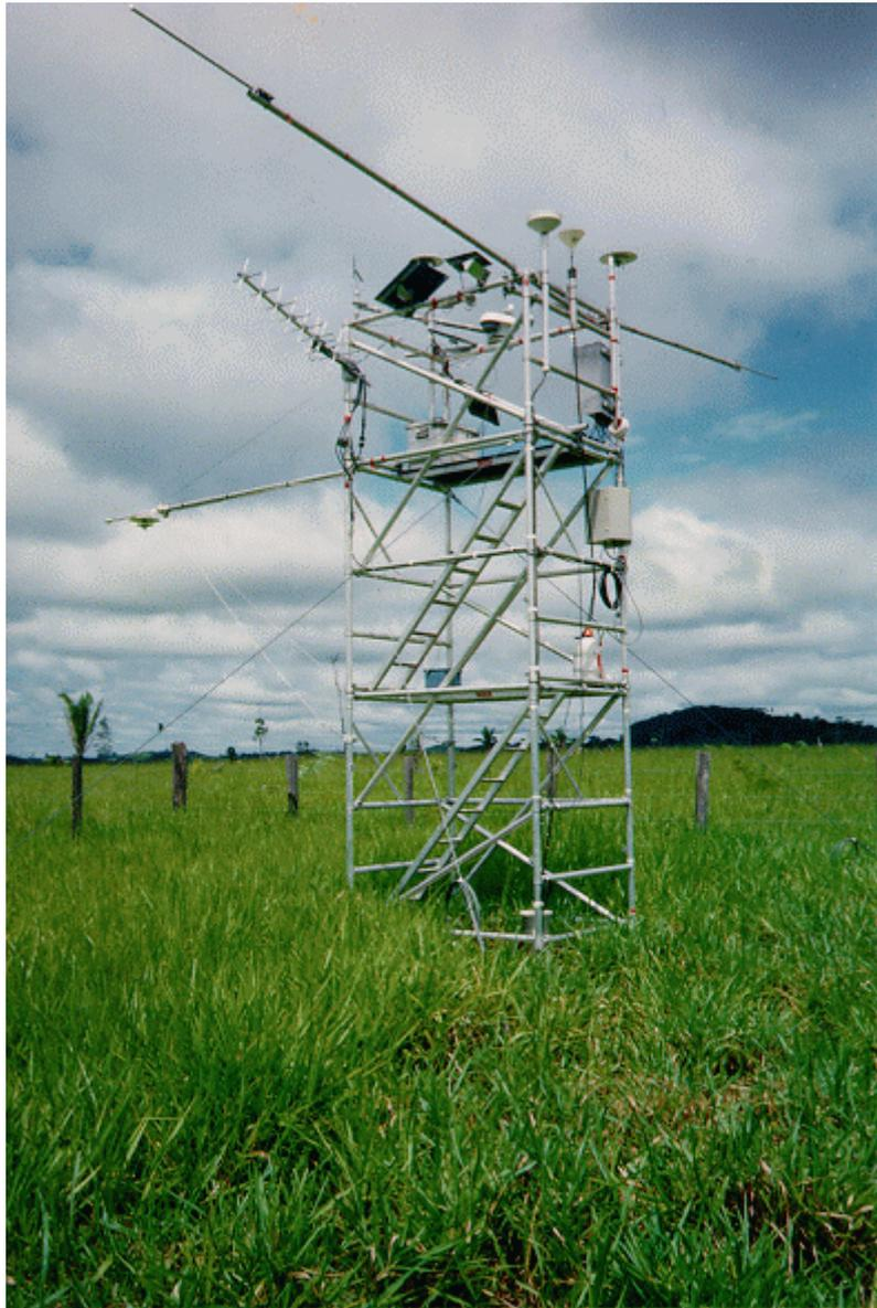
Fig. 3.4 - Estação Meteorológica Automática instalada na Fazenda Nossa Senhora de Aparecida, Ji-Paraná, RO.
