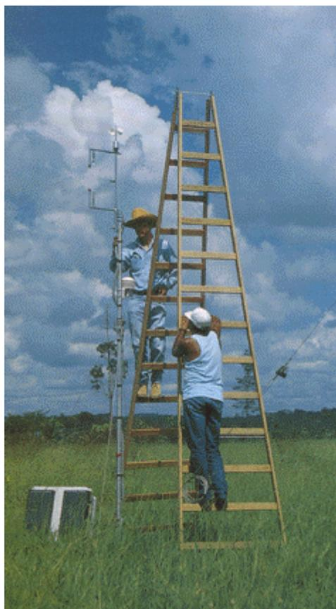
Fig. 3.5 - Equipamento de correlação de vórtice turbulento (HYDRA) instalado na Fazenda Nossa Senhora de Aparecida, Ji-Paraná, RO.
