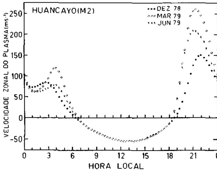
**Figura 2** - Variação diurna da velocidade e deriva zonal do plasma da região F a 350 km de altura sobre Huancayo, obtida usando o modelo M2 para os meses de dezembro de 1978 ( . . . ), março de 1979 (o o o) e junho de 1979 (x x x).
