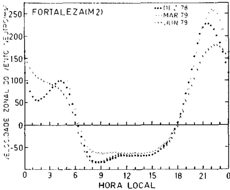
**Figura 4** - Variação diurna da componente zonal do vento neutro termosférico a 350 km sobre Fortaleza, obtida usando o modelo M2 para dezembro de 1978 ( . . . ), março de 1979 (o o o) e junho de 1979 (x x x).
