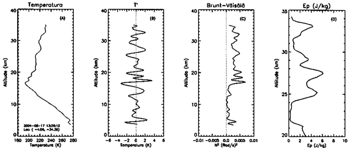
FIGURA 4.1 – (A) Perfil da temperatura observado no dia 17/08/2004 na região nordeste do Brasil ( $4,05^{\circ}S$ ;  $34,05^{\circ}O$ ) em torno das 13:26 UT. (B) Flutuação da temperatura. (C) Freqüência de Brunt-Väisälä ao quadrado. (D) Energia potencial entre 20 e 35 km de altura.
