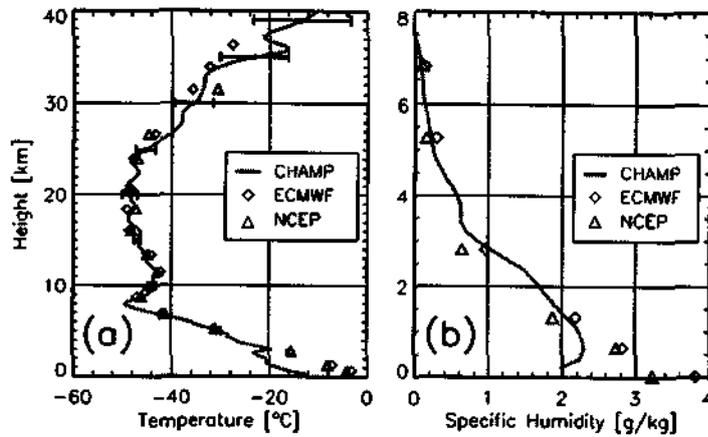
FIGURA 3.1 – Perfis verticais de (a) temperatura seca e (b) umidade específica calculadas a partir da ocultação número 5 em 11 de fevereiro de 2001 sobre o Atlântico Sul (53,2°S; 0,5°O; 19:43 UT) comparadas com dados do ECMWF e NCEP.
