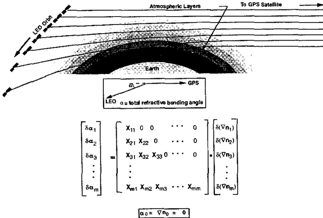
FIGURA 2.2 – Modelo *casca de cebola* da refração atmosférica. O gradiente do índice de refração é assumido como sendo constante dentro de cada camada. A continuidade na refratividade é exigida nas fronteiras onde a lei de Snell é aplicada. Começando numa taxa de sondagem de 3 Hz na alta atmosfera e reduzindo para 1 Hz na baixa troposfera, o número total de camadas (m) seria aproximadamente 100. A espessura das camadas seria em torno de 1 km.
