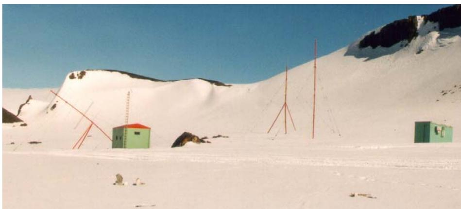
**FIGURA 1.5** – Da esquerda para direita: Antena apontada para o sul, módulo onde estão os riômetros, antena apontada para o oeste, antena apontada para o zênite e o módulo onde se encontra o computador de aquisição de dados digitais dos riômetros.
