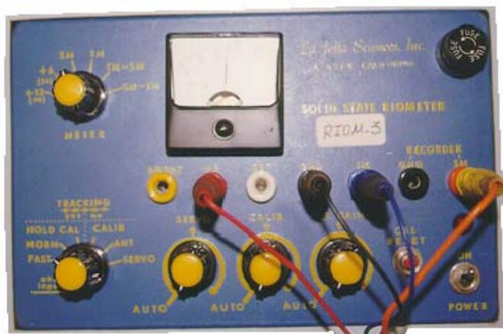
**FIGURA 1.8** – Aspecto externo de um riômetro.
