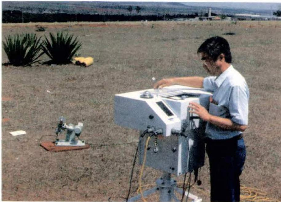
Apesar de automático, o instrumento Brewer só trabalha bem depois que um técnico competente faça uma instalação adequada. Além disto, são fundamentais as calibrações feitas com lâmpadas especiais. À esquerda vê-se também o pirheliômetro que junto com o sensor de UV-B informa sobre as condições da radiação da baixa atmosfera.
