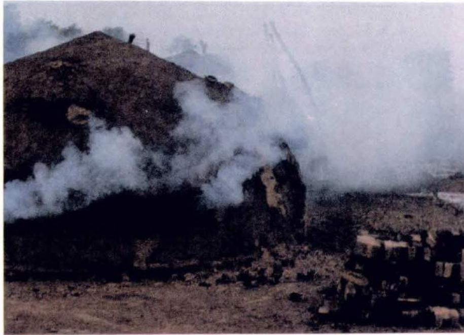
Fornos primitivos feitos de barro e tijolos mas bem específicos são construídos pelo carvoeiro para transformar a madeira, cortada no machado, em carvão. Os fornos são totalmente fechados com exceção de alguns furos por onde pode passar a fumaça. O processo é lento e gradual, onde a madeira "cozinha" até o ponto ótimo do carvão.
