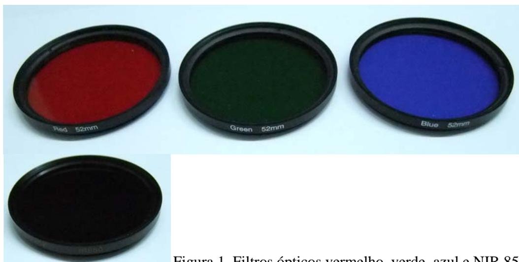
Figura 1. Filtros ópticos vermelho, verde, azul e NIR 850nm.
