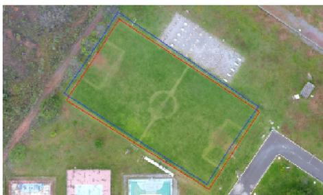
**Figura 2. Ortoimagem gerada sem ponto de controle do campo.**
