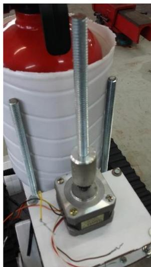
**Figura 6: União com motor de passo eixo sem fim.**
