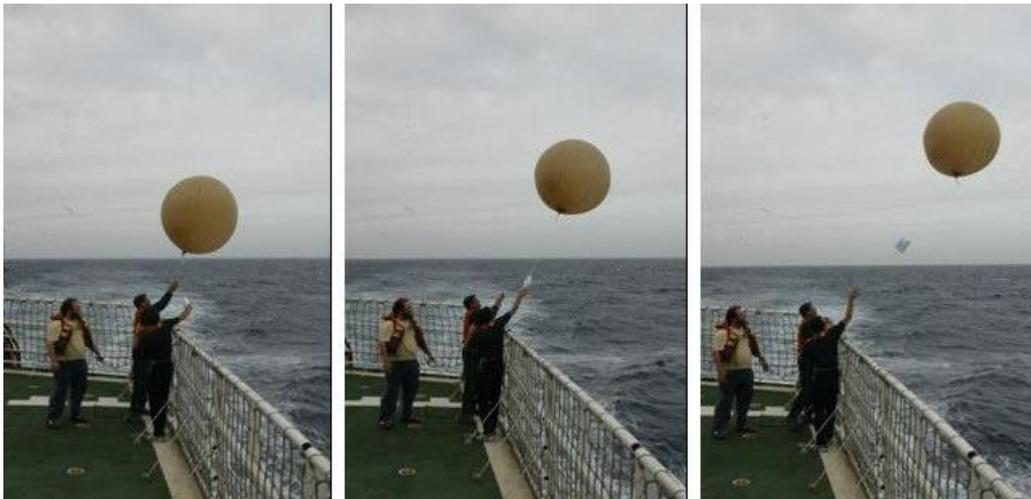
Figura 3.2 - Operação de lançamento de radiossondas atmosféricas realizado em novembro de 2004 a bordo do NApOc Ary Rongel.
