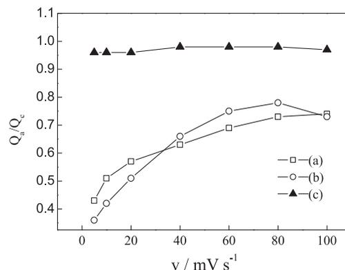
**Figura 6.**  $Q_a/Q_c$  versus  $v$  para o DDB nas três diferentes soluções eletrolíticas. (a)  $0,1 \text{ mol L}^{-1} \text{ HClO}_4 + 10^{-3} \text{ mol L}^{-1} \text{ CuSO}_4$ ; (b)  $0,1 \text{ mol L}^{-1} \text{ H}_2\text{SO}_4 + 10^{-3} \text{ mol L}^{-1} \text{ CuSO}_4$  e (c)  $0,5 \text{ mol L}^{-1} \text{ Na}_2\text{SO}_4 + 10^{-3} \text{ mol L}^{-1} \text{ CuSO}_4$ , respectivamente. Velocidade de varredura de  $20 \text{ mV s}^{-1}$
