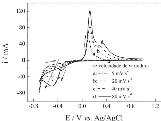
**Figura 5.** Voltamogramas cíclicos dos processos de deposição e dissolução de Cu sobre o DDB obtidos em uma solução contendo  $1,0 \times 10^{-3} \text{ mol L}^{-1} \text{ CuSO}_4 + 0,1 \text{ mol L}^{-1} \text{ HClO}_4$  em diferentes velocidades de varredura
