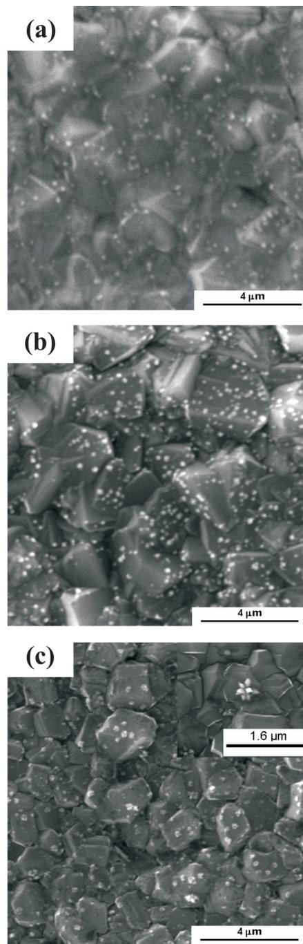
Figura 2S. Imagens MEV dos eletrodepósitos de Cu sobre DDB nas três soluções eletrolíticas. (a) 0,1 mol L<sup>-1</sup> HClO<sub>4</sub> + 10<sup>-3</sup> mol L<sup>-1</sup> CuSO<sub>4</sub>; (b) 0,1 mol L<sup>-1</sup> H<sub>2</sub>SO<sub>4</sub> + 10<sup>-3</sup> mol L<sup>-1</sup> CuSO<sub>4</sub> e (c) 0,5 mol L<sup>-1</sup> Na<sub>2</sub>SO<sub>4</sub> + 10<sup>-3</sup> mol L<sup>-1</sup> CuSO<sub>4</sub>, respectivamente
