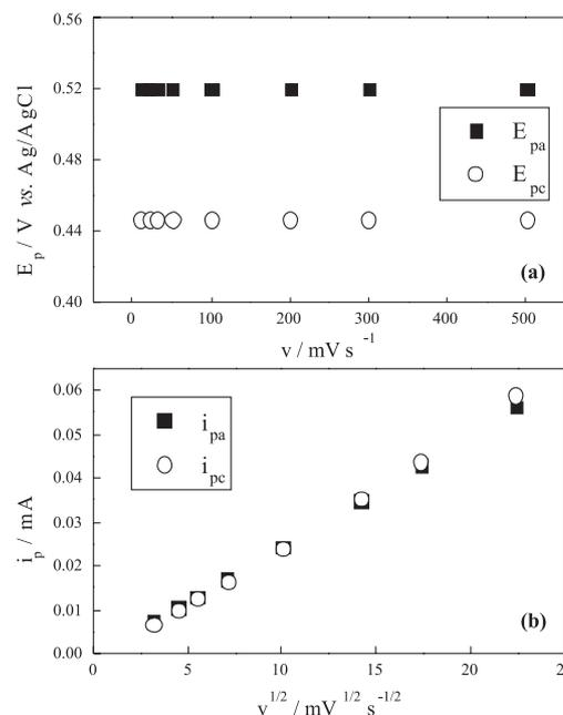
**Figura 3.** (a)  $E_{pa}$  e  $E_{pc}$  em uma função da velocidade de varredura; (b)  $i_p$  versus  $v^{1/2}$  para o eletrodo DDB obtidos em solução contendo  $1,0\text{ mmol L}^{-1}$   $\text{K}_4\text{Fe}(\text{CN})_6 + 0,1\text{ mol L}^{-1}$   $\text{H}_2\text{SO}_4$
