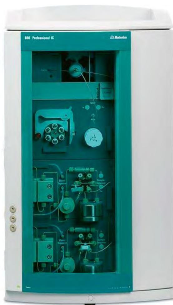
Figura 2.1 – Cromatógrafo de íons 850 Professional IC (Metrohm).
