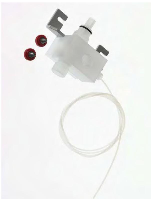
Figura 2.2. Célula eletroquímica para IC (Metrohm).
