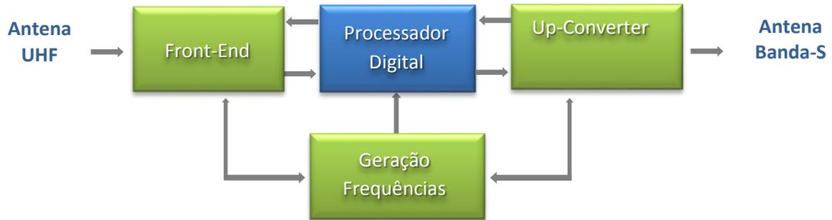
Figura 5. Diagrama de Blocos do Transponder
