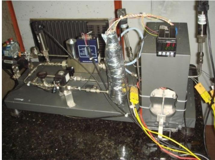
Figura 4.21 - Melhorias na instrumentação da bancada de testes.
