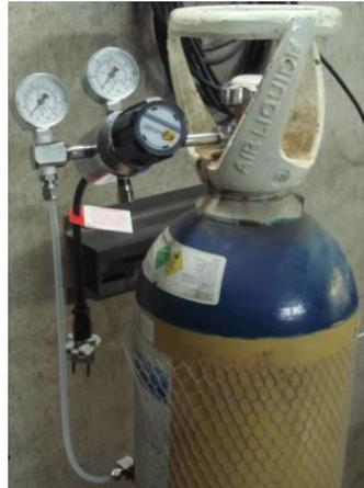
Figura 4.3 - Cilindro com N<sub>2</sub>O e regulador de pressão aquecido.
