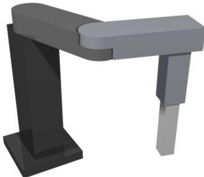
Fig. 2.16 – Robô com articulação horizontal SCARA.
