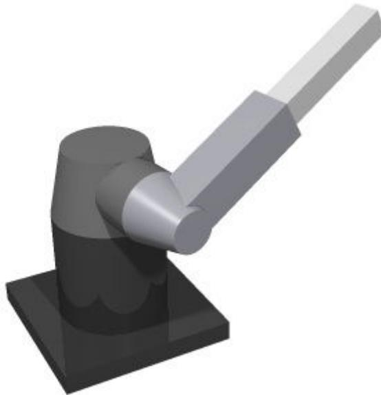
Fig. 2.15 – Robô polar em configuração *VVL*.
