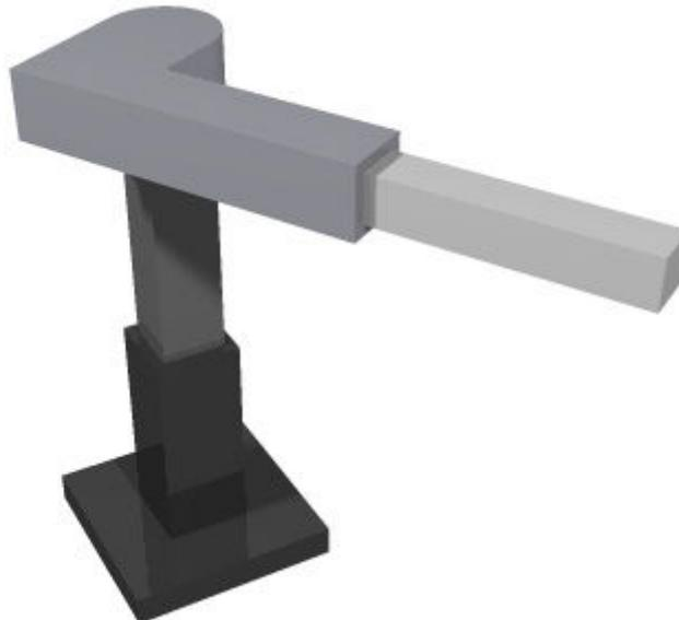
Fig. 2.14 – Braço robótico cilíndrico
