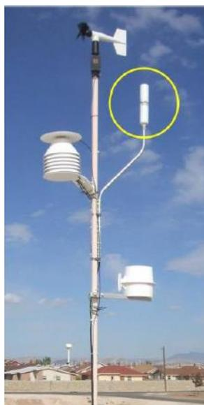
Figura 2.3 – Sensor instalado em uma estação meteorológica (círculo amarelo).
