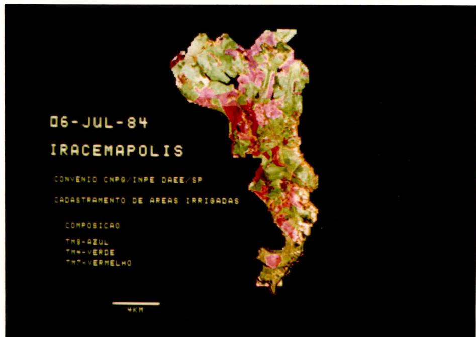
Fig. 7 - Composição colorida em falsa-cor utilizando as bandas TM3 (azul), TM4 (verde) e TM7 (vermelho).
