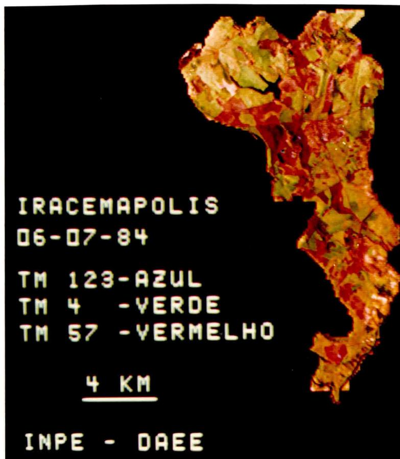
Fig. 8 - Composição colorida em falsa cor obtida pela combinação das bandas TM na faixa reflexiva do espectro electromagnético.
