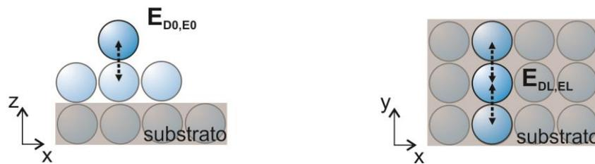
Ilustração de um átomo, no modelo computacional, que possui: (a) uma ligação fora do plano e (b) duas ligações ( $n = 2$ ) no plano.
