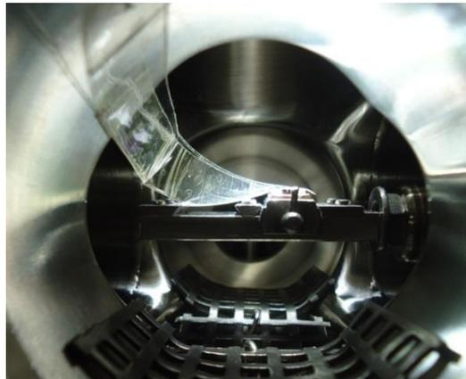
Montagem experimental de uma amostra de  $\text{Bi}_2\text{Te}_3$  com capa protetora de Te dentro da câmara de preparação do sistema de análise de superfície imediatamente antes da remoção da capa.
