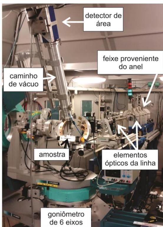
Fotografia do aparato experimental para difração de raios X instalado na linha XRD2 do Laboratório Nacional de Luz Síncrotron.
