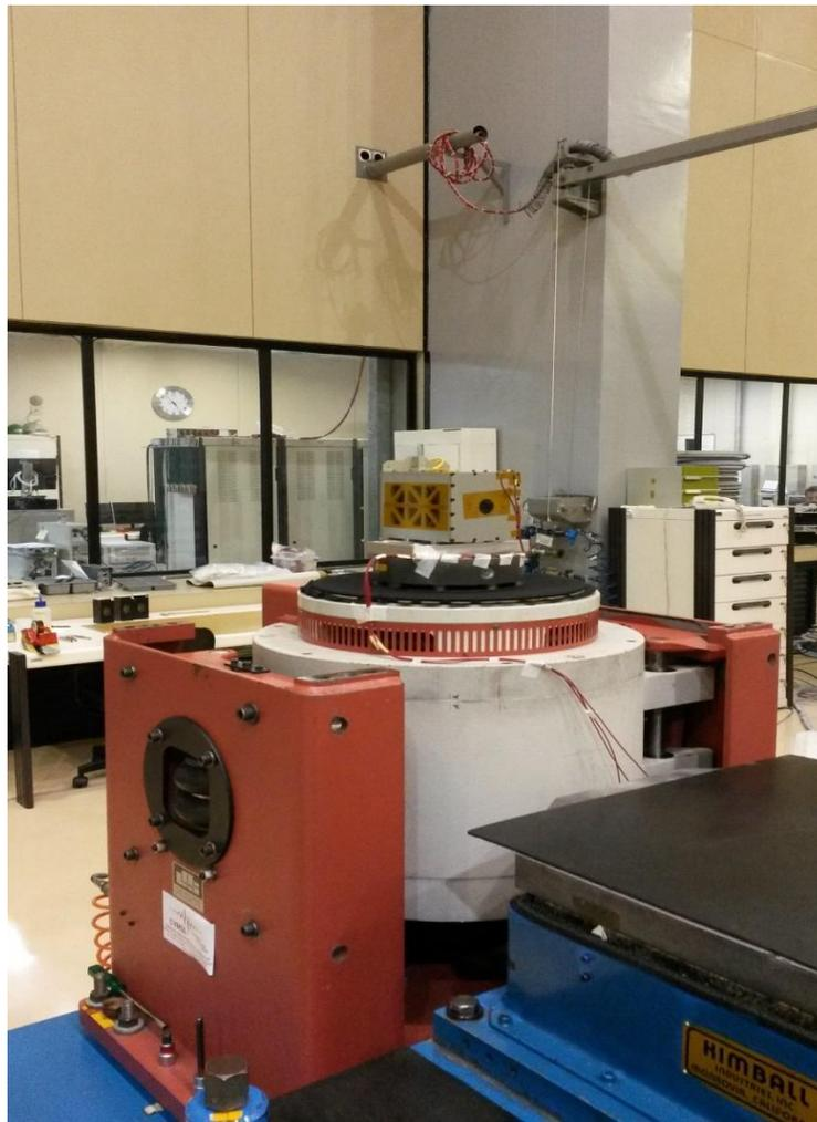
Figura 8: Teste de vibração mecânica no NANOSATC-BR1
