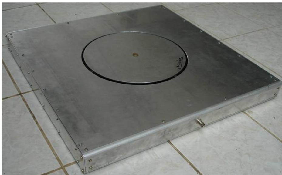
FIGURA 2.2 – Antena plana utilizada em medidas de campo elétrico.
