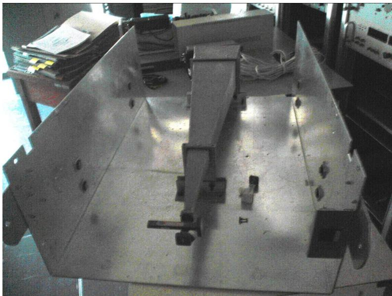
Figura 3.1.2 - Corneta retangular para a freqüência de 22 GHz.
