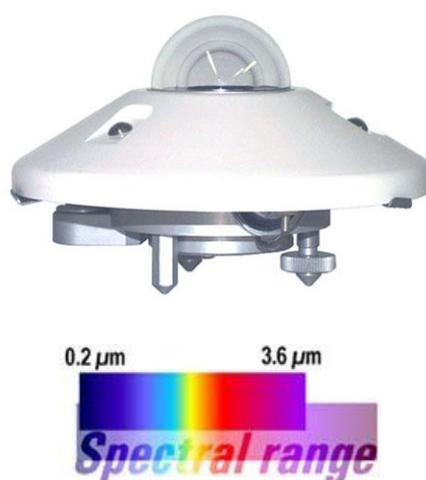
Figura 4.2 – Piranômetro CM 22 (Kipp&Zonen) e seu intervalo espectral.
