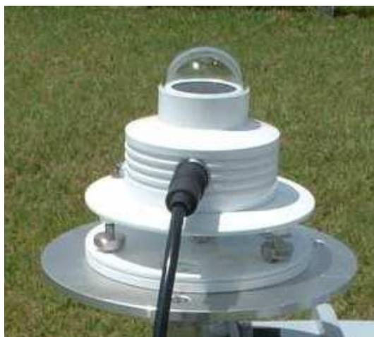
Figura 4 - Biômetro UV501A (Radiação UVB - 280-320 nm)
