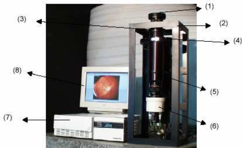
**Fig. 3-Imageador CCD all-sky sendo: (1) lente do tipo all-sky ; (2) rack; (3) sistema telecêntrico de lentes; (4) roda de filtros de interferência ótica; (5) sistema de reconstrução da imagem; (6) câmara CCD; (7) sistema de refrigeração da câmara CCD e (8) microcomputador.**
