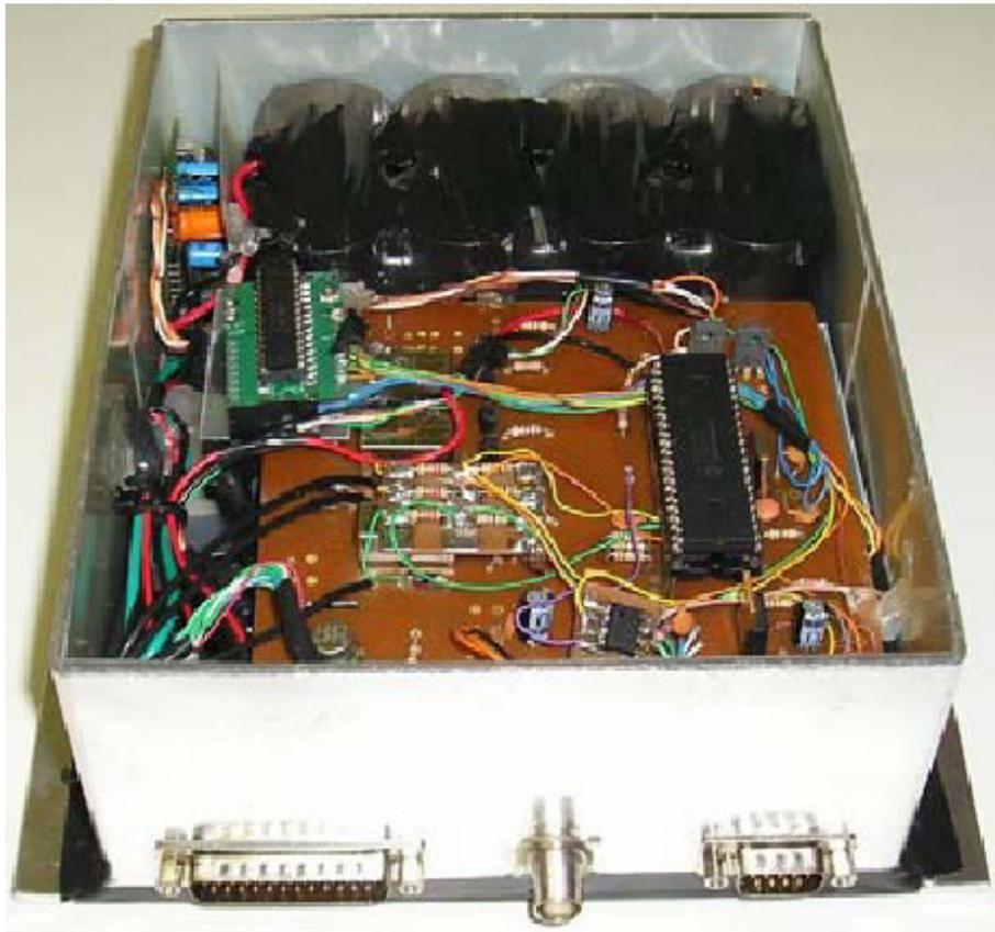
**Fig. 20: Equipamentos internos fixados após a aplicação da resina**
