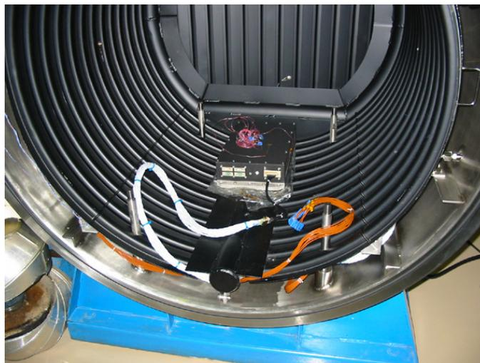
**Figura 17: Estrutura de teste de termo vácuo**
