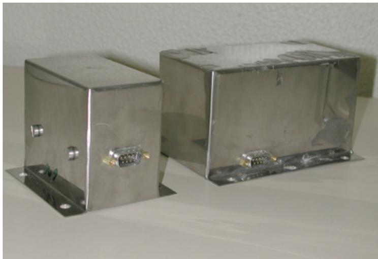
**Figura 14: Baterias Nicad e Li-MnO<sub>2</sub>**
