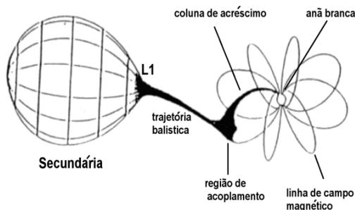
**Figura 1 - Representação de uma polar e descrição das componentes do sistema.**
