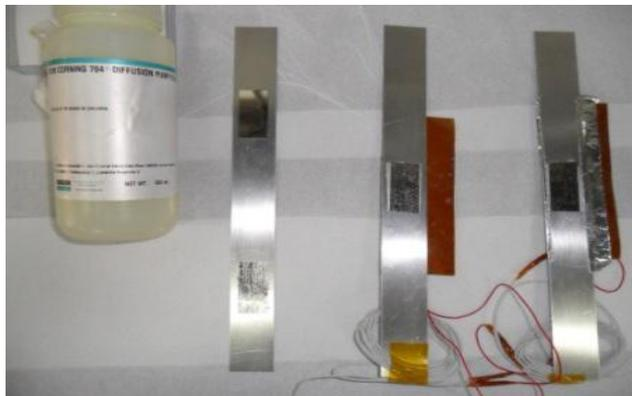
**Figura 2:** Amostras fixadas e contaminadas com o DC-704.
